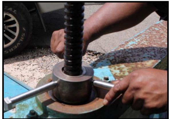
KUNCI GATE LOCK STEERING DENGAN MENGUNAKAN SHAFT
